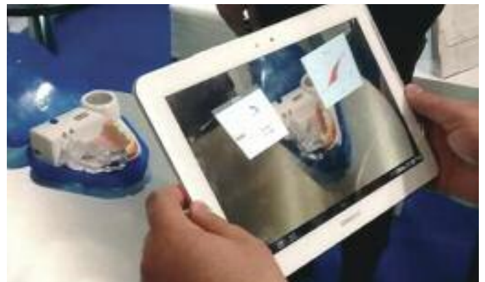
Illustration 4 : La réalité augmentée, permet d'afficher sur un écran ou des lunettes intelligentes des données choisies du fichier patient rien qu'en mettant le modèle dans le champ de la caméra (ici c'était un modèle de démonstration).
